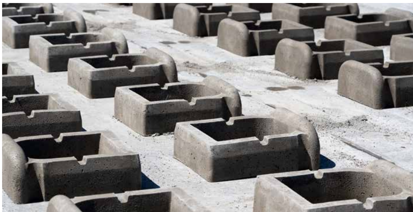
Proceso de secado de piezas componentes de un muro Alpenstein.
