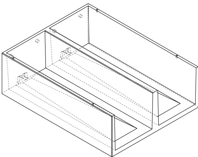
(1) - **Orificios de ventilación** (ø45 mm) de gases preabiertos, a finalizar en el momento del enterramiento.
