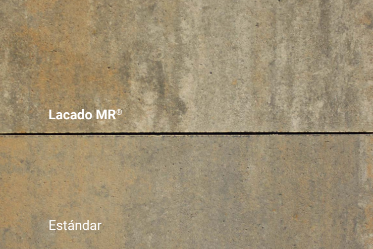
Fig. 2 | De nuevo, se aprecia la diferencia entre la pieza lacada (superior) y sin tratamiento (inferior). Fuente: elaboración propia, Ecomyrsa.
